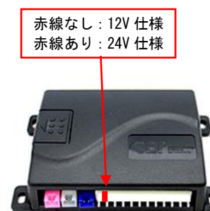
制御装置 (サイズ: 87 × 70 × 28 mm) 1セット
